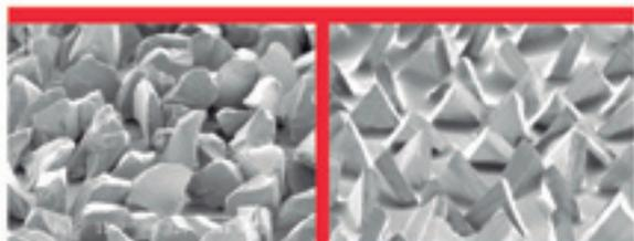
Grão mineral microrreplicado (imagem da direita) é eletrostaticamente orientado para formar seu ângulo de corte, cada um atuando como ferramenta de corte individual. Dura muito mais e produz acabamentos mais uniformes.
