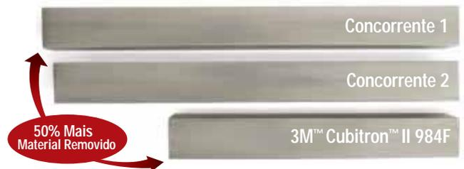
Essa foto mostra 4 barras de inox 304 idênticas após 9 ciclos de desbaste, cada um com 10 segundos. As três barras que foram desbastadas usando correias cerâmicas convencionais mostram variação de oxidação enquanto a barra desbastada com a nova correia contendo CUBITRON<sup>TM</sup> II não apresenta variação alguma.
