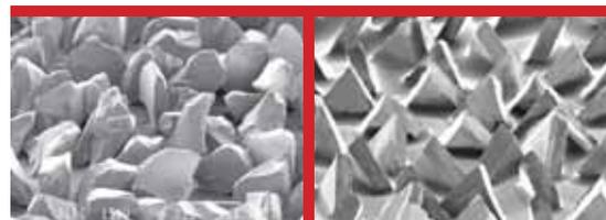
Grão mineral microrreplicado (imagem da direita) é eletrostaticamente orientado para formar seu ângulo de corte, cada um atuando como ferramenta de corte individual. Dura muito mais e produz acabamentos mais uniformes.
